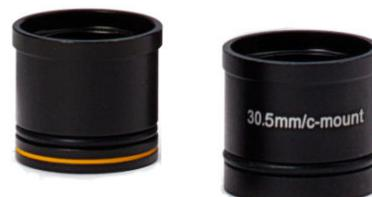
Les caméras sans objectif de projection peuvent être directement visées sur un adaptateur à monture C (avec bague de 5 mm) ou CS (sans la bague de 5 mm)
