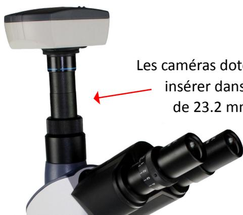
Les caméras doté de l'objectif de projection peuvent être insérer dans un tube standard de microscope au diamètre de 23.2 mm. Des bagues de conversion de 30 ou 30.5 mm vers to 23.2 mm permettent l'insertion de la camera dans des microscopes stéréoscopiques ou loupes
